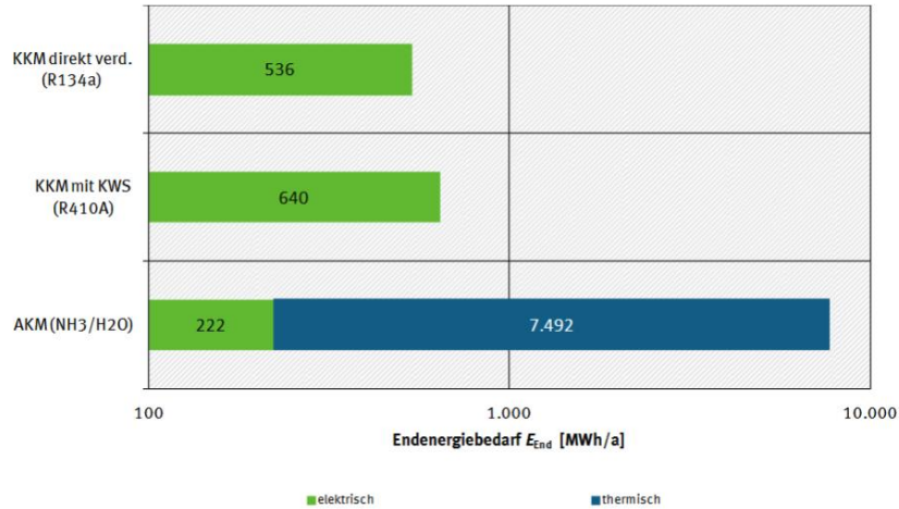
Jährlicher Endenergiebedarf untersuchter Systeme für Prozesskälteerzeugung
