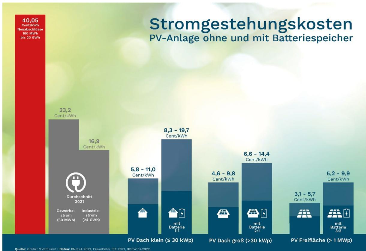
*BU: Stromerzeugungskosten je Kilowattstunde mit der eigenen Photovoltaikanlage mit und ohne Speicher im Vergleich zum Strompreis des Versorgers (Abbildung: LEKA MV)*
